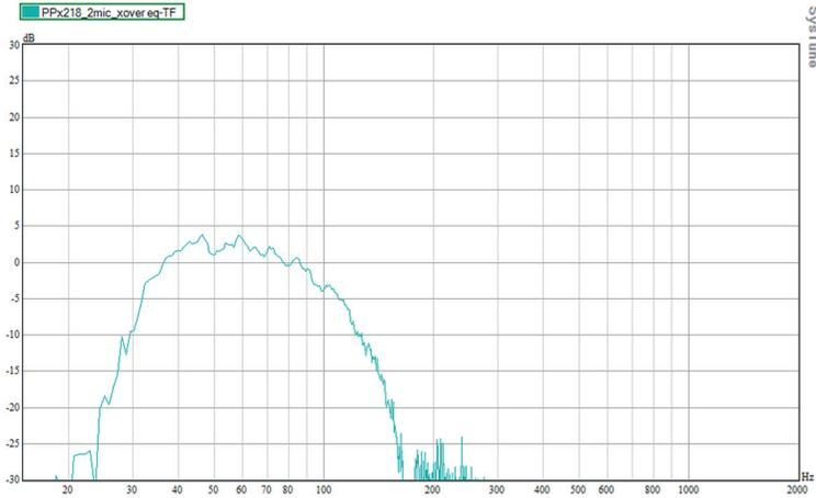
El gráfico mostrado cuenta con cortes de frecuencia LPF y HPF con el fin de reproducir exclusivamente baja frecuencia en un rango de 31- 115Hz (-6dB).
